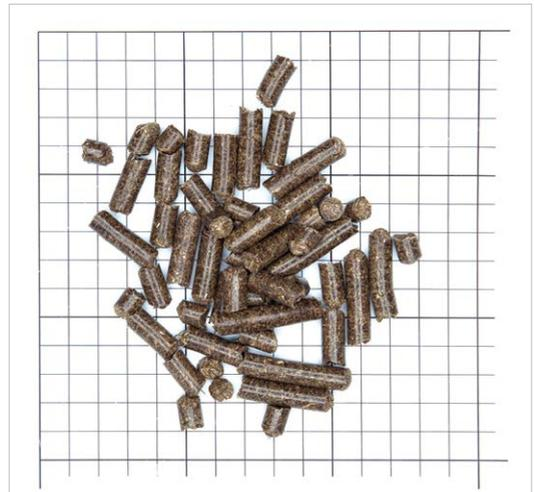
**Abb. 5.1** Seggenpellets aus der mobilen Pelletierung für Verbrennungstests (Schilfpellets s. Abb. 3.9)
