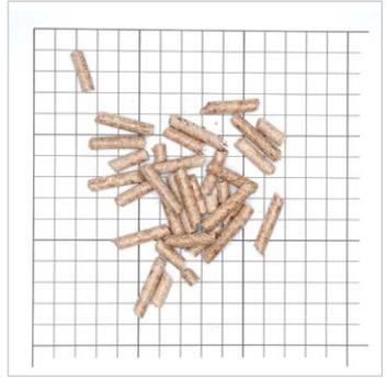
Voraussetzung für die Kompaktierung ist ein Wassergehalt deutlich unter 20 %. Um dies zu erreichen, muss ggf. eine energieintensive Trocknung erfolgen.
