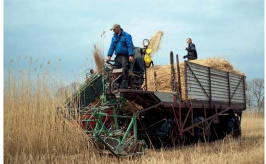
Bei **raupenbasierter Technik** handelt es sich in der Regel um Einzellösungen ausgehend von umgebauten Pistenraupen aus Skigebieten. Die breiten Ketten führen trotz relativ schwerer Maschinen zu geringem Bodendruck (50-100 g/cm<sup>2</sup>), können allerdings bei Fehlbedienung oder zu häufigem Überfahren desselben Standortes ebenfalls zu Bodenschädigungen führen [18, 19].
