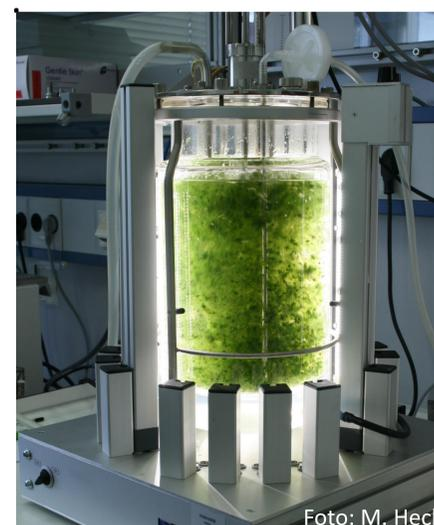
und im Photobioreaktor. Unter keimfreien Bedingungen und bei Düngung nach Verbrauch kann so in weniger als einem Monat das 40fache der Ausgangsmenge an reinem Torfmoosmaterial produziert werden.
