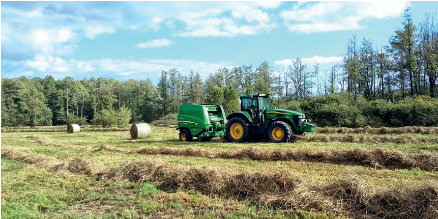
Abb.: Seggenkompaktierung mit angepasster Grünlandtechnik zur energetischen Verwertung im Spreewald (09/2019, Foto: F. Birr)
