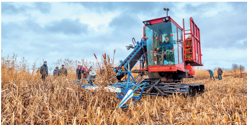
Abb.: Rohrkolbenmähd mit raupenbasierter Technik (12/2018, Foto: lensescape.org)
