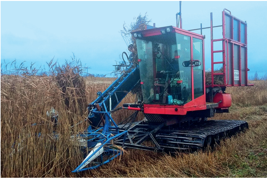
Abb.: Schilfmahd mit raupenbasierter Technik (12/2018, Foto: F. Birr).
