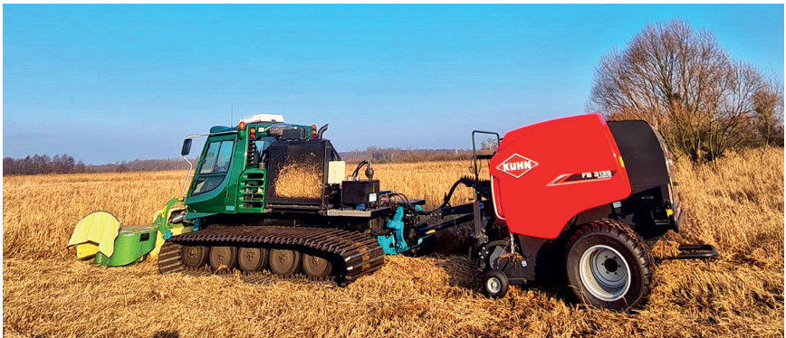
Abb.: Raupenbasierte Zugmaschine (umgebauter PistenBully 200) und Rundballenpresse mit Breitreifen (Foto: S. Petri)
