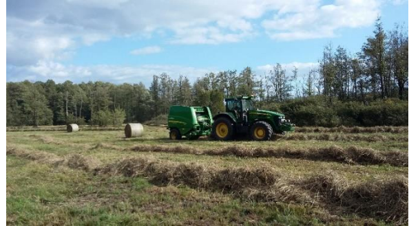
Abb. 1: Kompaktierung von Seggen-Biomasse zur anschließenden energetischen Verwertung. Foto: F. Birr, 09/2019.
