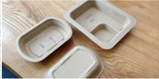
7 Formteile aus Schilf (Foto: S. Abel)
