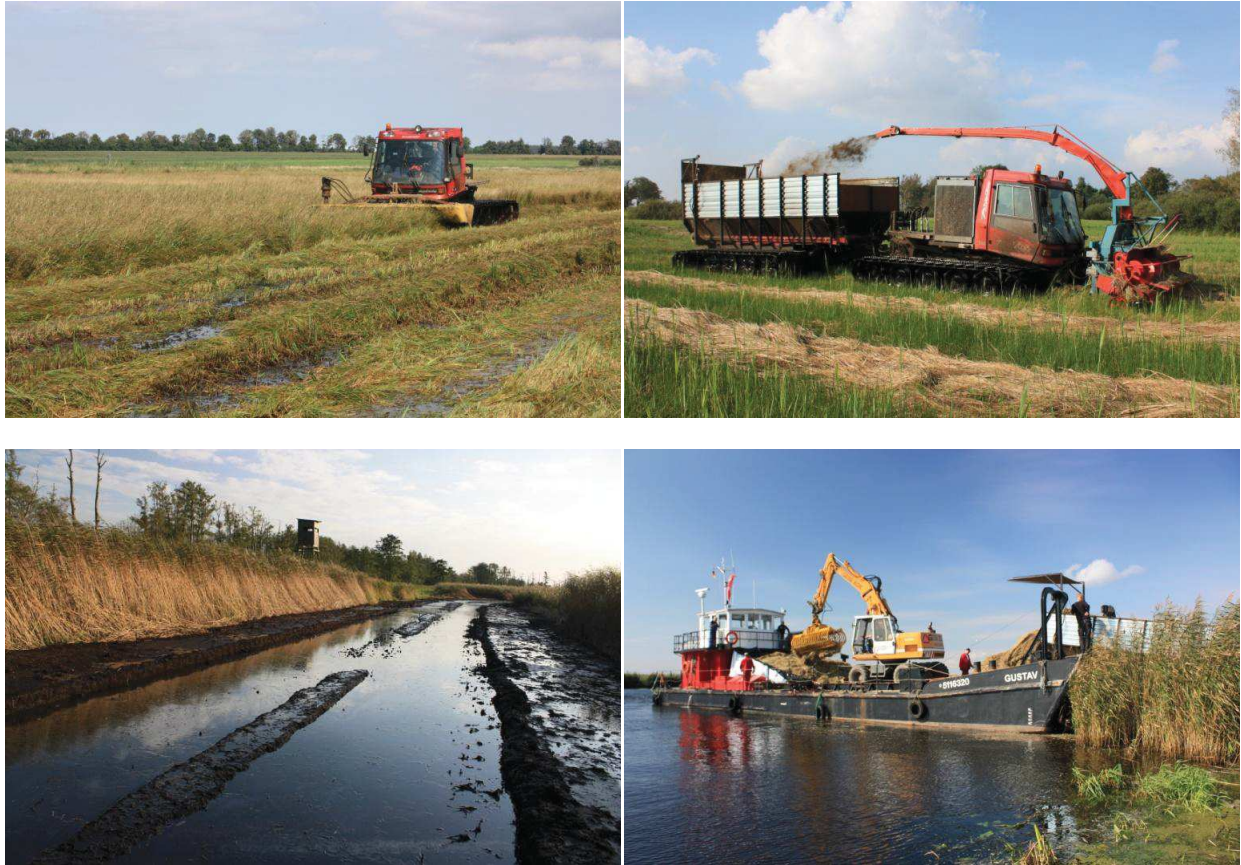
Abb. 14a-d: Ernte von Biomasse nasser Moorstandorte im Rahmen des Verbundprojektes VIP – Vorpommern Initiative Paludikultur. Im Uhrzeigersinn: a) Mahd und Ablage der Biomasse im Schwad; b) Häckseln und Abtransport; c) Schäden an Fahrtrasse; d) Abtransport der Biomasse per Schiff. Fotos: C. Schröder.
