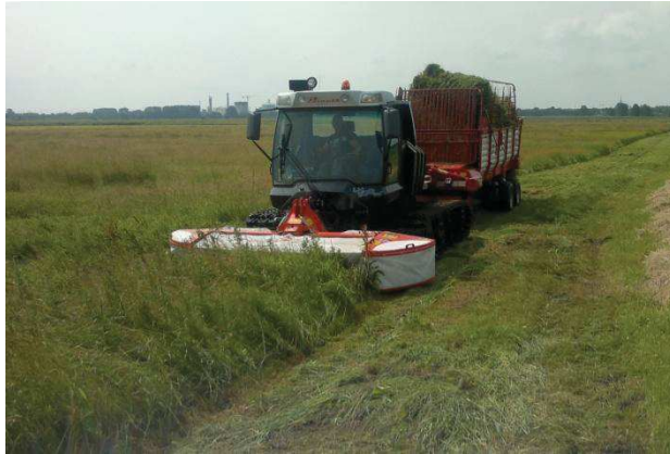
Abb. 15. Spezialtechnik der Bioenergie Neu Kosenow GmbH & Co. KG. Mahd der Biomasse mit einer Pistenraupe und anschließende Aufnahme und Abtransport der Biomasse über einen Ladewagen. Foto: C. Saul.
