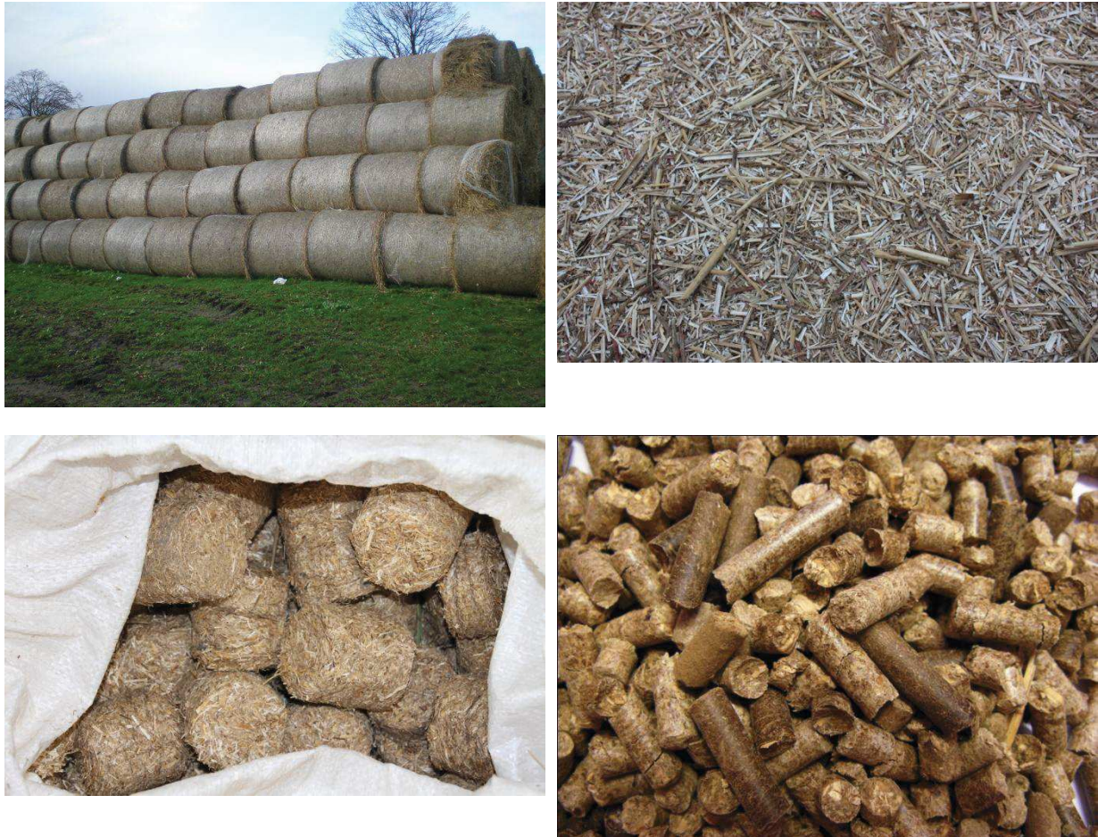
Abb. 11 a-d. Festbrennstoffe aus Paludikultur. Im Uhrzeigersinn: a) Ballen; b) Schilfhäcksel; c) Schilfbriketts; d) Schilfpellets. Fotos: W. Wichtmann (a); C. Schröder (b); N. Körner (c); T. Dahms (d)
