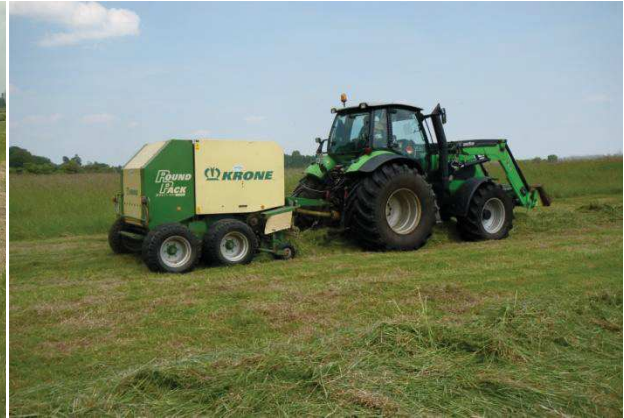
Abb. 16: Ernte von Biomasse nasser Moorstandorte mit angepasster Spezialtechnik des Landwirtschaftsbetriebes Voigt, Neukalen. Foto: C. Schröder.
