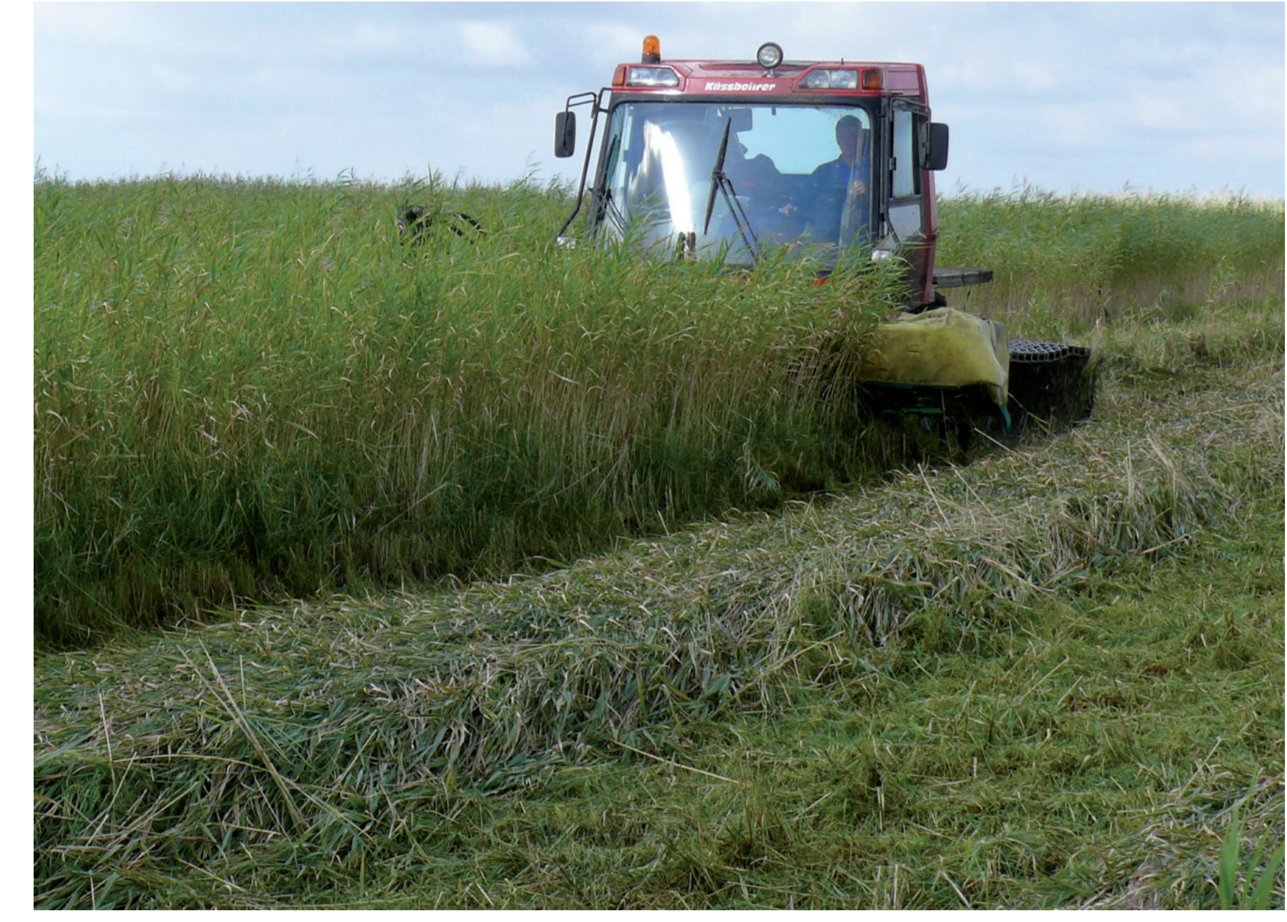
Abb. 1: Mahd mit Spezialtechnik auf Raupenbasis (S. Wichmann).
