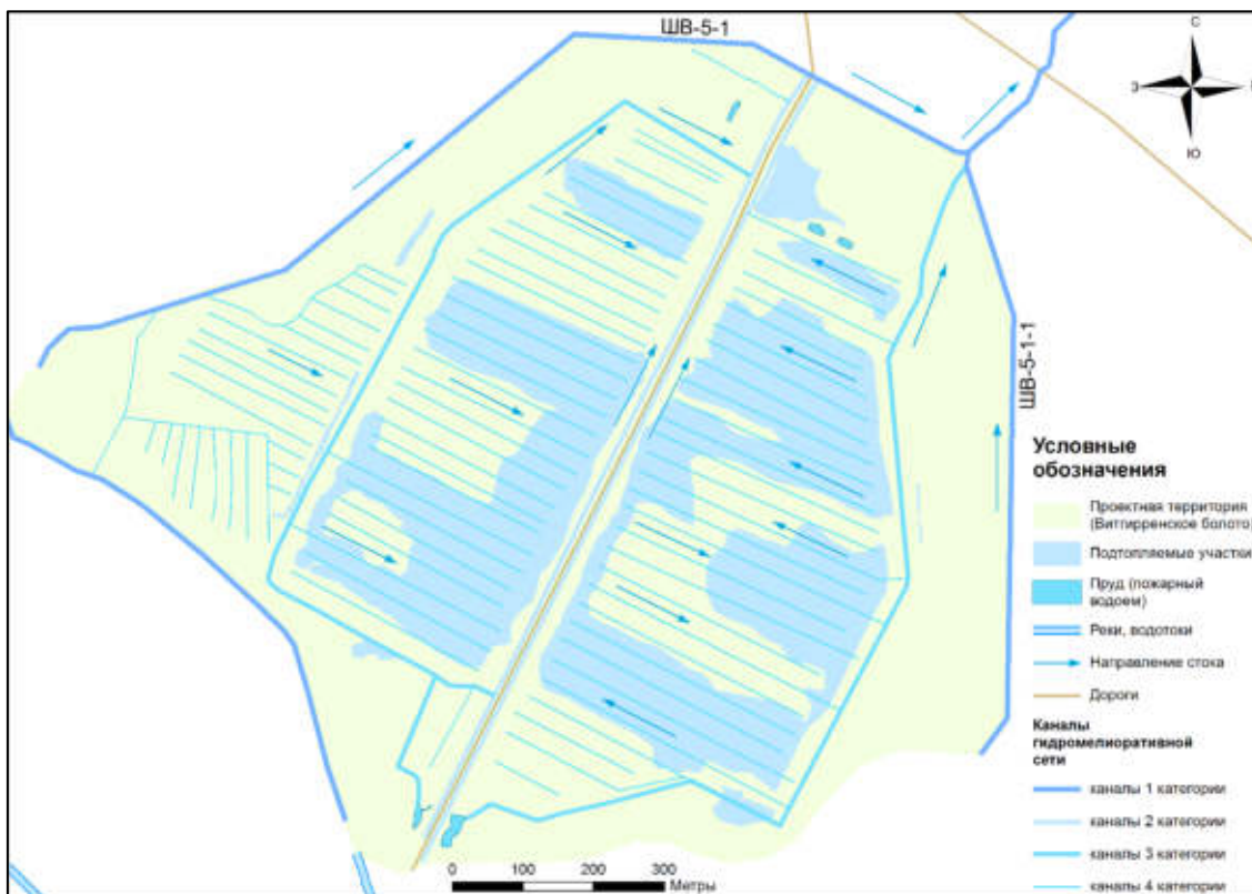
Рис. 10. Схема гидромелиоративной сети проектной территории торфяника «Виттгирренское»
