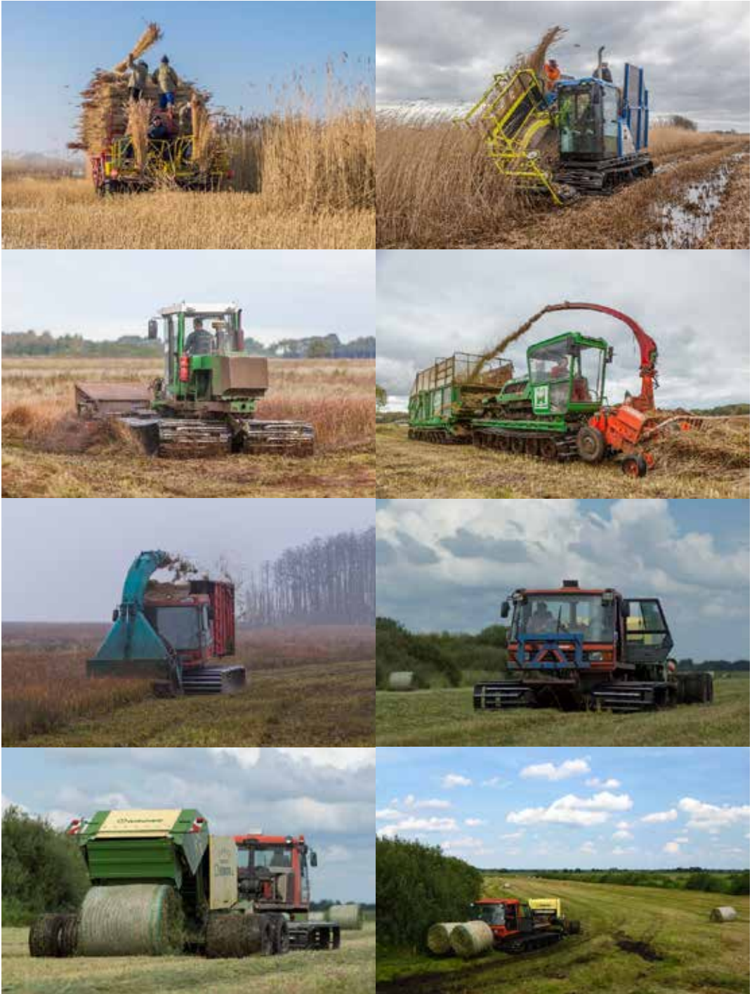
Abb. 33: Verschiedene Erntemaschinen und -verfahren für die Landschaftspflege/Ernte auf nassen Mooren. Varianten: Ballonreifen Seiga für die Ernte von Schilfbündeln (Foto: P. Schroeder), moderne Schilferntemaschine auf Kettenbasis, zweistufiger Grashäcksler auf Kettenbasis, einstufiges Verfahren auf Kettenbasis mit Schlegelmulcher und 9 m 3 Bunker und dreistufige Rundballen-Ernte-Verfahren auf Kettenbasis. Sommer- und Winterernte. (Fotos: links oben von P. Schroeder, alle Übrigen von T. Dahms)
